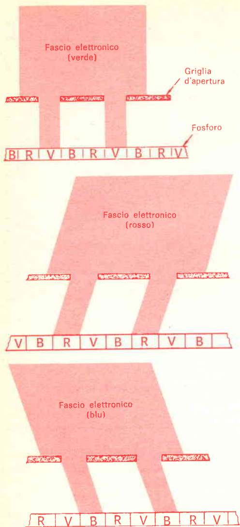
Fig. 4 - Nel trinitron, l'angolo di ogni fascio elettronico determina quale fosforo viene colpito. Il fascio elettronico è più largo delle strisce e così può colpire due strisce di fosforo contemporaneamente.
